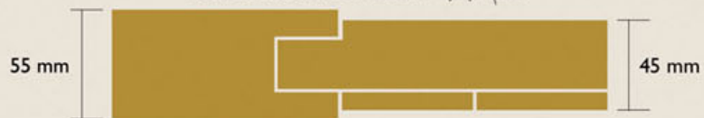
Sección Puerta / Door section / قسم الباب
